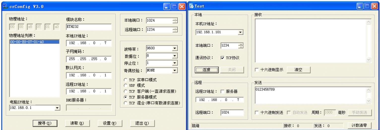
通过Config设置后ETH232GH产品可以脱离计算机。此时向ETH232GH的以太网口(RJ-45口)传送的TCP/IP协议数据将自动转换为串口的RS-232协议数据。同样此时向串口传送的RS-232协议数据将自动转换为ETH232GH以太网口(RJ-45口)的TCP/IP协议数据。只要原来可以通过以太网访问本产品所设置的以太网IP地址，那么也就可以通过以太网读写连接在本产品的串上的设备数据了。
