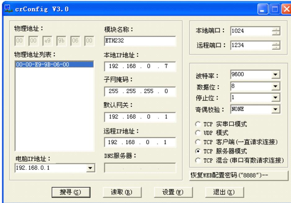
另外一台 ETH232 用作客户端【选“TCP 客户端（一直请求连接）”】，设置如下图。注意：1、“本地端口”和“远程端口”的地址与另外一台 ETH232 的设置正好相反。2、模式选“TCP 客户端（一直请求连接）”。3、“本地 IP 地址”必须与另外一台 ETH232 的 IP 地址最后一位不同，前几位必须一样。4、最重要的是“远程 IP 地址”必须设置为另外一台 ETH232 的“本地 IP 地址”。
