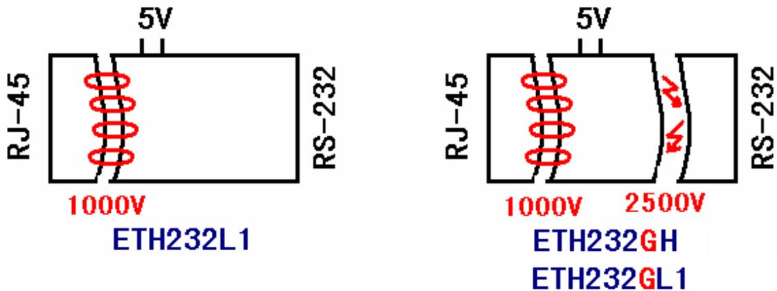
ETH232GH、ETH232GL1 不仅以太网（RJ-45）与串口之间有变压器隔离（1000V），而且还增加了一道对串口的2500V光电隔离，实现了以太网（RJ-45）、外接电源、串口（RS-232/485/422）三方的隔离。ETH232GH的RS-232/485/422的最高通信速率为115.2Kbps。ETH232GL1的RS-232/485/422的最高通信速率为19.2Kbps。波仕ETH232GH、ETH232GL1内置有600W抗雷击浪涌保护器。
