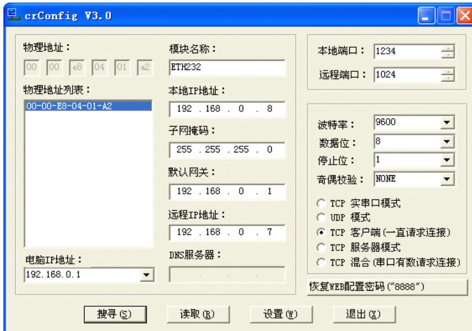
必须将两台串口服务器的串口参数设置成一致，并和您使用中的串通信采用的串口参数一致。如你的串口通讯线路使用的是9600bps，那么在两台 ETH232 的“串口设置”中都必须都设置成 9600bps，其他的串口参数也必须保持一致。
