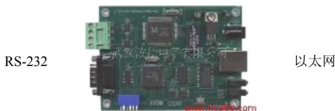
图1 波仕电子的ETH232的内部电路板
