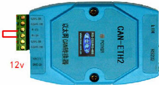
用电线将 RESet1 与 RESet2 短接、然后再插 12v 电源。过 15 秒钟后拔下电源，再断开 RESet1 与 RESet2。
