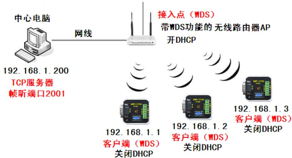
**设置要点：多机同网段、WDS 功能用的 SSID 要一样，WDS 主机开 DHCP，WDS 副机关 DHCP。**
