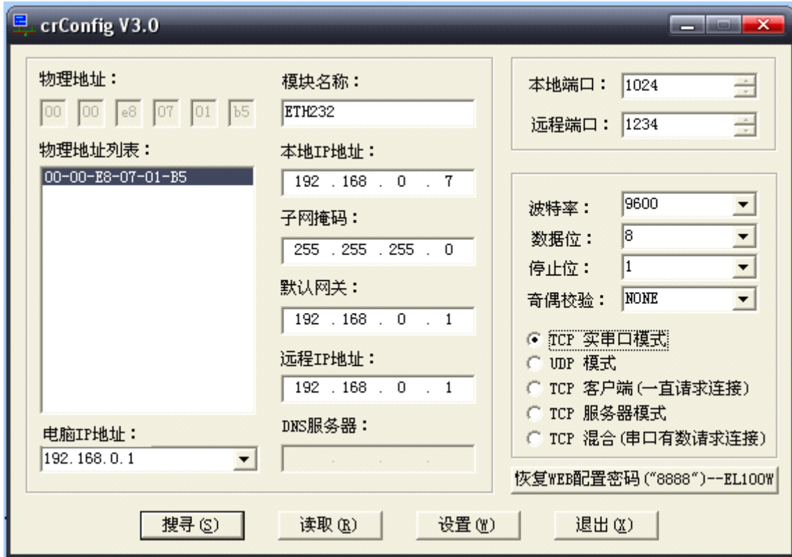
图 10 将每个 ETH232GL1 的工作模式都选择为“TCP 实串口模式”并按“设置”。
